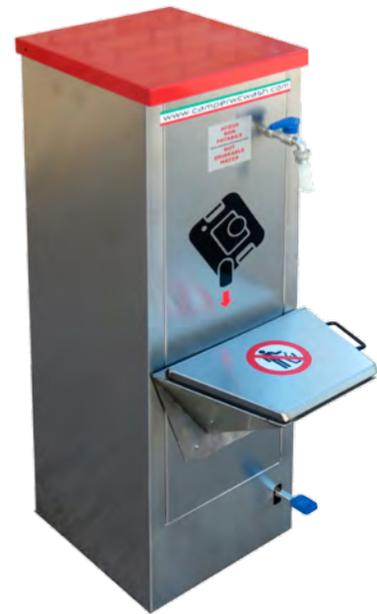
Columna de descarga v-304-RP en acero inoxidable que realiza la función de vaciado del casete extraíble, con sistema auto-limpiable mediante dos boquillas accionadas por pedal. Incorpora un grifo para el enjuague del casete.
