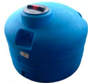
Sistema de lavado dotado de una planta con depósito de polietileno para uso subterráneo o para insertar en una base de hormigón, bomba sumergida de flotación. Se recomienda su implantación cuando la presión del agua es demasiado baja para la limpieza adecuada del sumidero de descarga.
