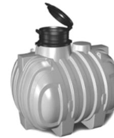
La serie C-STEEL son tanques para el almacenamiento de residuos campistas para soterrar. Fabricados en polietileno de baja densidad lineal (LLDPE), con capacidades de 3 a 36 metros cúbicos. Equipados con uno o más tapones (según modelo) con tapa de registro para inspección.
