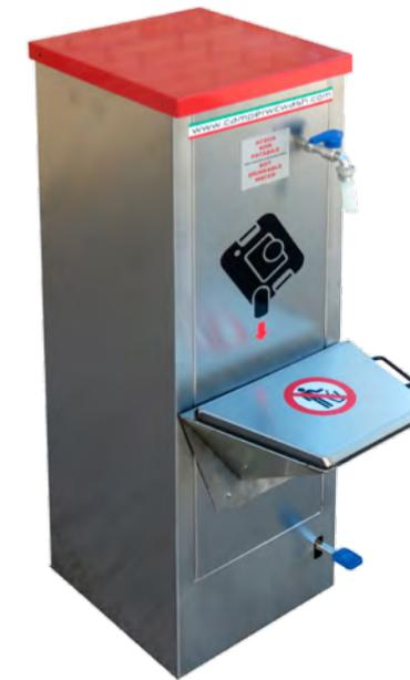
Columna de descarga v-304 en acero inoxidable que realiza la función de vaciado del casete extraíble, con sistema auto-limpiable mediante dos boquillas accionadas por fotocélula o pulsador temporizado. Incorpora un grifo para el enjuague del casete. Precisa de conexión eléctrica 220v.
